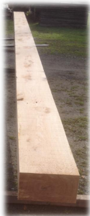
Débit de charpente 10.50m en chêne
